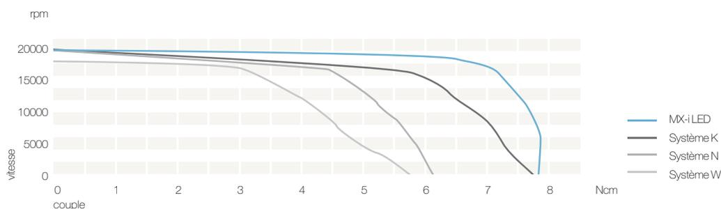
Le micromoteur MX-i LED est d'abord un exemple de stabilité. A haute comme à basse vitesse, il vous offre un grand confort de travail. Le couple important du MX-i LED en fait l'un des micromoteurs les plus puissants du marché. En fonction du couple nécessaire, la puissance est régulée et stabilisée par système électronique. De ce fait, la vitesse est maintenue avec une grande précision durant toute l'opération.
