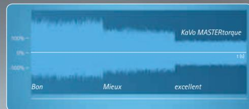
Comparaison du niveau sonore de KaVo MASTERtorque avec celui d'autres turbines
