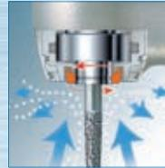
Le système Clean Head breveté de NSK est un mécanisme qui a spécialement été conçu pour empêcher automatiquement l'introduction de fluides oraux et d'autres organismes infectieux dans la tête de la turbine, prolongeant ainsi la durée de vie des roulements.
