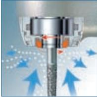
Le système Clean Head breveté de NSK est un mécanisme qui a spécialement été conçu pour empêcher automatiquement l'introduction de fluides oraux et d'autres organismes infectieux dans la tête de la pièce à main, prolongeant ainsi la durée de vie des roulements.
